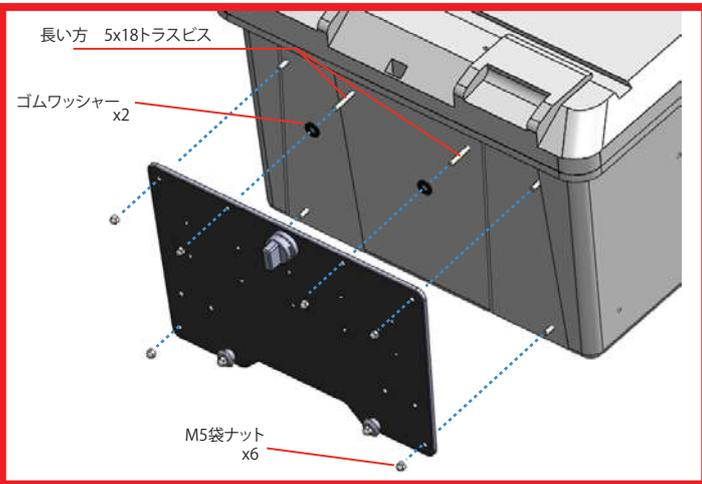
あらかじめマジックで印をつけた6箇所をドリルで穴をあけます。図のようにボックス内側よりトラスビスを差込み、袋ナットで固定します。
