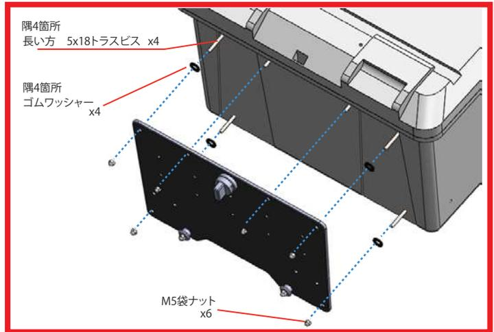
あらかじめマジックで印をつけた6箇所をドリルで穴をあけます。図のようにボックス内側よりトラスビスを差込み、袋ナットで固定します。
